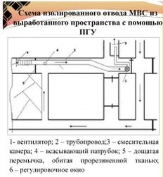
**Схема изолированного отвода МВС из выработанного пространства с помощью ПГУ**
