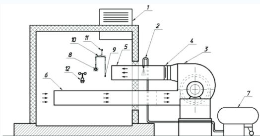
**Схема блока модернизации климатической камеры:** 1 – холодильная установка; 2 – блок форсунок; 3 – вентилятор; 4 – шиберная заслонка; 5 – нагнетательный воздушный канал; 6 – обратный воздушный канал; 7 – насосная станция; 8 – образец (провод); 9 – эталонный стержень; 10 – тензодинамометр; 11 – датчик температуры воздуха; 12 – датчик скорости воздушного потока
