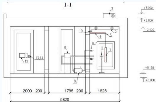
**Общий вид климатической камеры ДонНАСА:** 1 – холодильная камера, 2 – теплая камера, 3 – операторская комната. Схема экспериментальной установки: 1 – испытуемый профиль; 2 – холодная камера; 3 – компрессор VL-75; 4 – рычаг; 5 – электронный динамометр; 6 – форсунки; 7 – распылитель; 8 – компрессор; 9 – ветровая установка; 10 – датчик температуры и влажности; 11 – анемометр; 12 – персональный компьютер; 13 – регулятор TRM138; 14 – приборы СИ-8, ПКП-1
