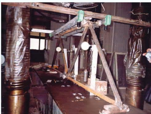
Испытание блока структурной конструкции в гидравлическом прессе (P=1000 т)
