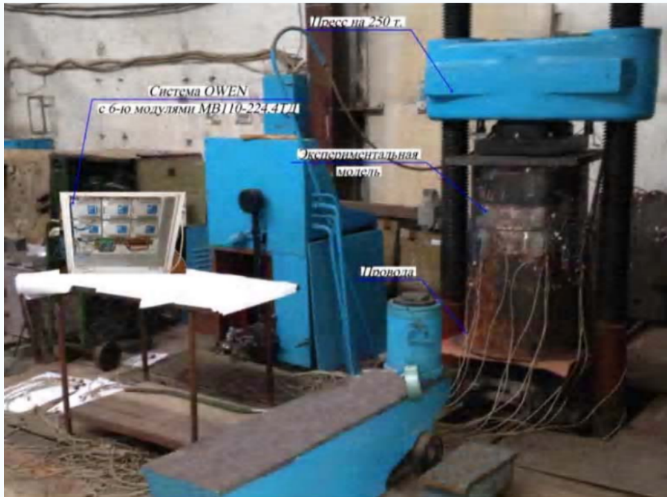
Общий вид испытательной установки для изучения влияния эксцентриситета стыковки цагг на напряженно-деформированное состояние оболочек металлических дымовых труб
