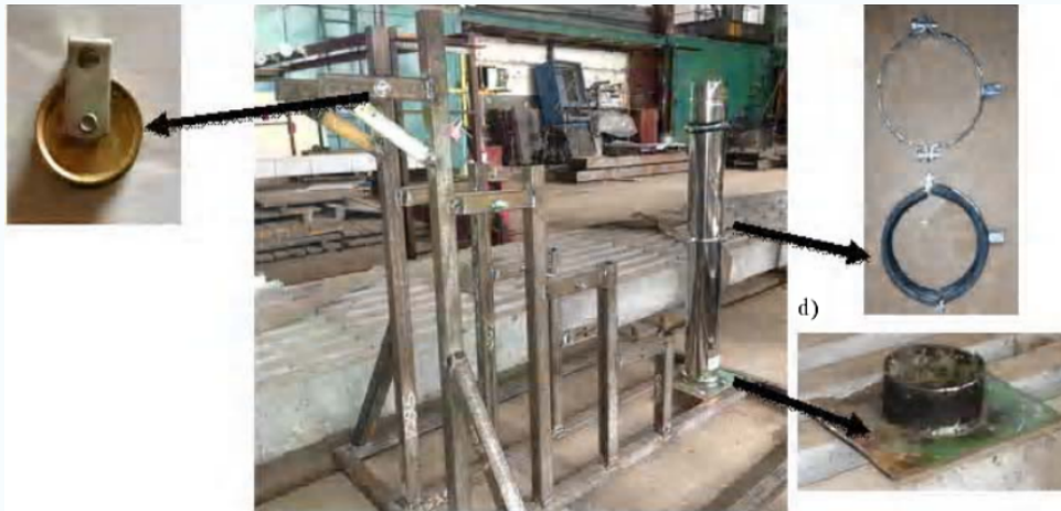
Общий вид лабораторной установки и главных конструктивных элементов: а – лабораторная установка с исследуемой моделью; б – шкив для передачи нагрузки; с – опорное кольцо; d – опорная часть
