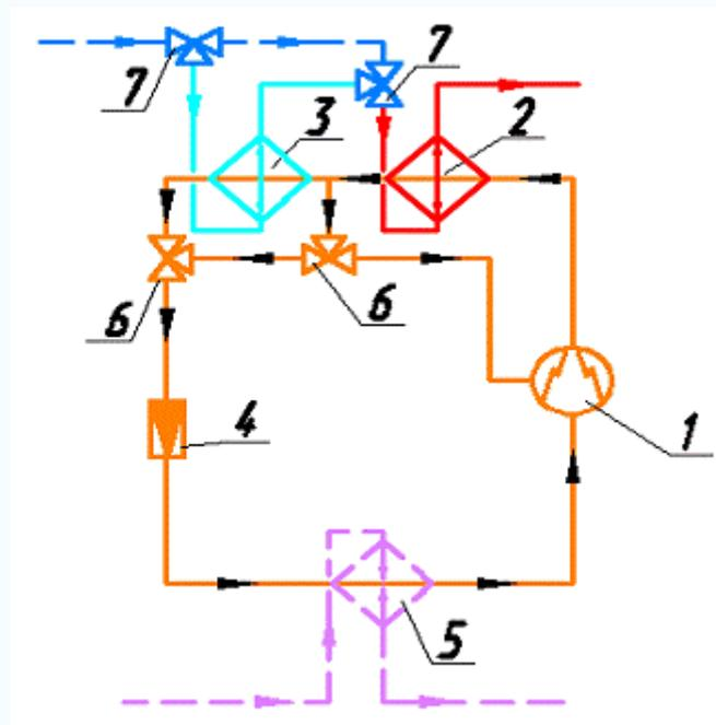
– метантенк для сбраживания биомассы (Патент на полезную модель №90880. Биогазовая установка с системой утилизации тепла)
