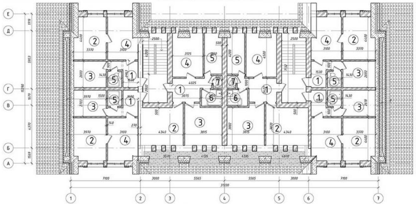
Рисунок 2. План 3-го этажа на отметке + 6,400 М 1:100
